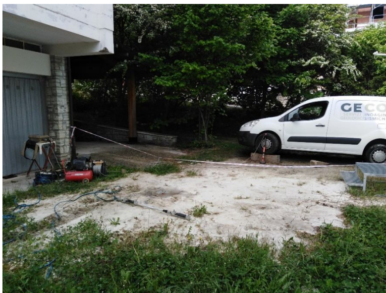
Fig. 5: Particolare dell'acquisizione con metodologia down-hole;
