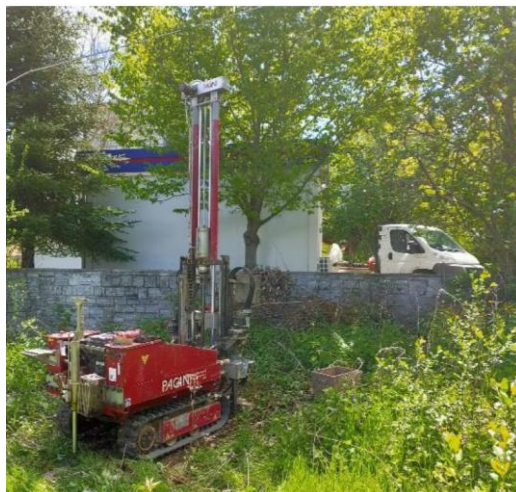
Foto 10 - Esecuzione prova penetrometrica
