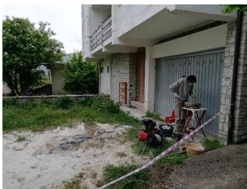
Foto 9 - Esecuzione prova sismica in foro DownHole DH
